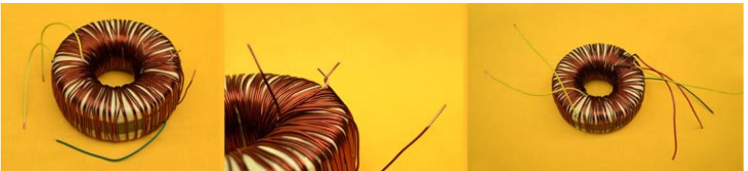
La siguiente comprobación se hace con el multímetro en escala de voltaje AC. Al medir entre el **TAP** y cada uno de los extremos del alambre, el voltaje debe dar totalmente simétrico, es decir que debe dar un voltaje idéntico. Siempre use el [Circuito Serie](#) hasta tener completamente terminado el transformador.
