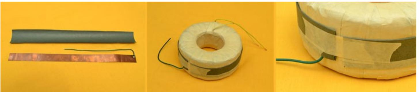
Esta lámina rodeará el transformador y se fija con cinta. Este apantallamiento de cobre sirve para evitar posibles escapes de magnetismo que puedan interferir con los circuitos, especialmente si hay preamplificadores o circuitos de pequeñas señales.
