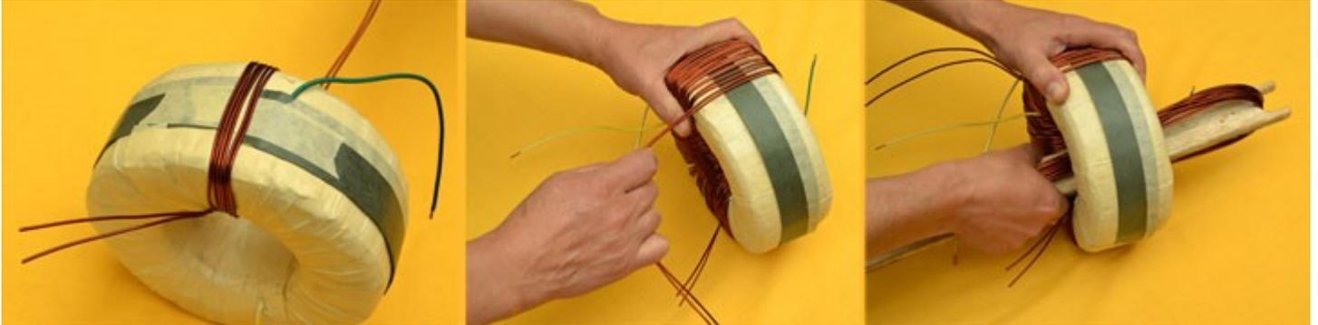
Para esto debemos enrollar el alambre doble. Así, que primero se enrollan los metros calculados en el lanzador, siendo dos alambres iguales y luego se enrolla en el toroide de manera ordenada y muy ajustada.
