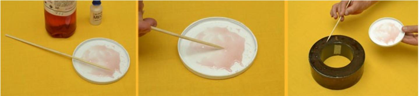
El MEC se debe aplicar con moderación. Por lo regular son unas pocas gotas de MEC para una porción de 4 cucharadas de resina. Entre más MEC se agregue a la mezcla, más rápido se endurece la resina y se corre el riesgo de que se cristalice, perdiendo su elasticidad. Así que es mejor, agregar poco MEC para que de esta forma se mantenga maleable más tiempo para aplicar debidamente la resina.
