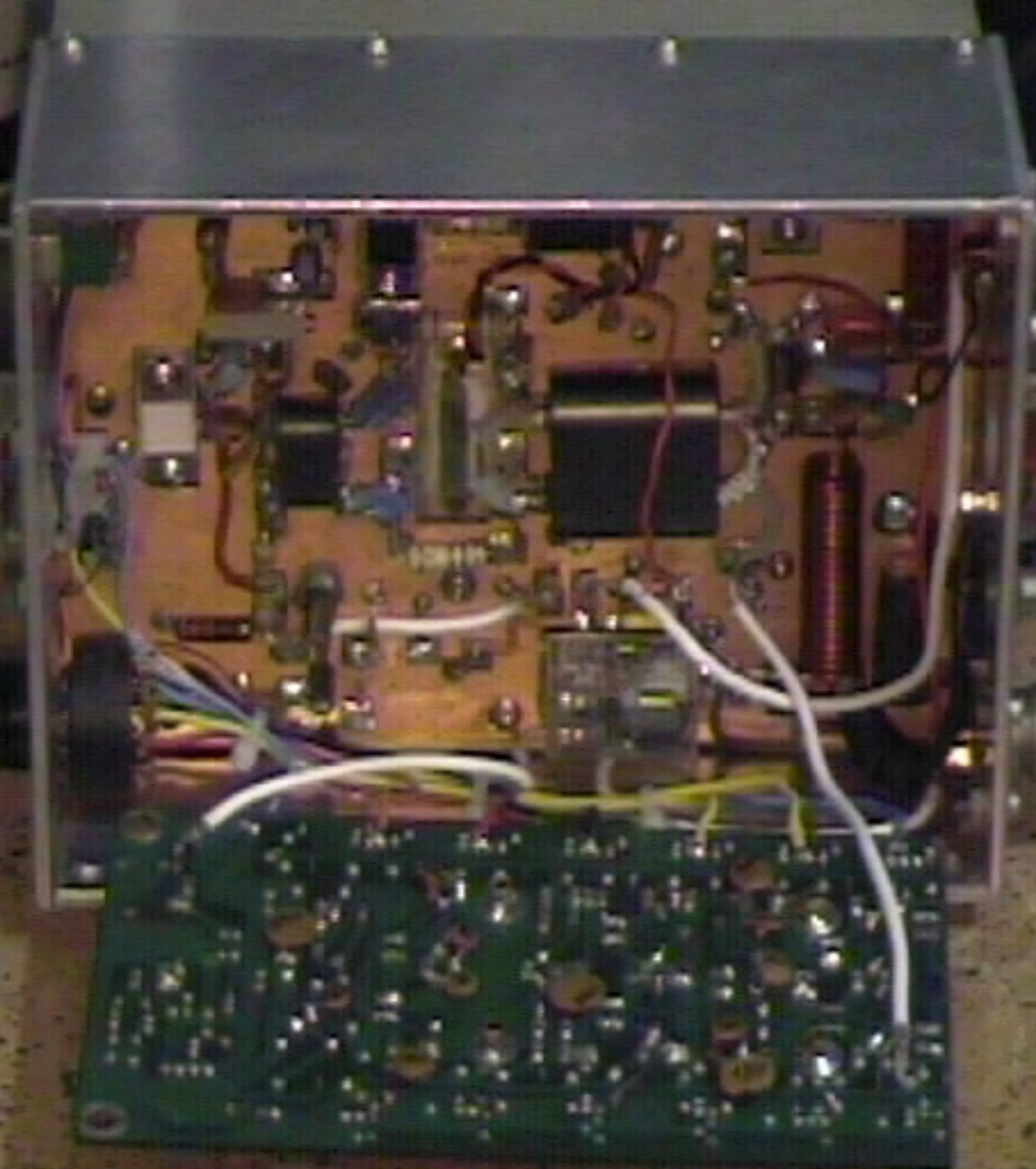
Amplificador EA1KO usando una placa de filtros de TS-940
