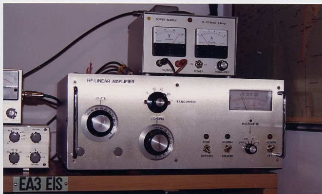
Figura N°7: Vista exterior del Amp Lin HF Multibanda;de izquierda a derecha:Los mandos de sintonía,Plate y Loading;el Selector de Bandas:15,20,40 y 80 Met;a continuación,los conmutadores de palanca y leds indicadores:Tune-Operate,Normal-Standby,Power-Off;el selector del Multimeter SWR-PO-IP-HV y el instrumento de cuadro móvil con las respectivas escalas.
