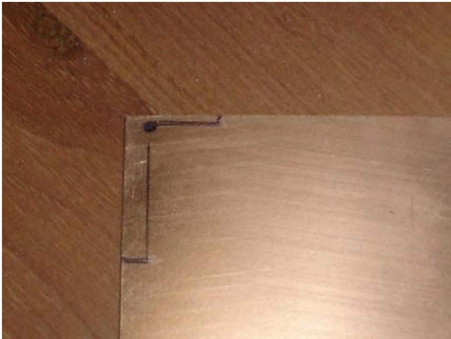
Para cortarlo seguimos el procedimiento que explique antes ( dremel o cegeta y cortar al ras de las lineas del dibujo). Y ya tenemos el elemento donde va soldado el dipolo.
