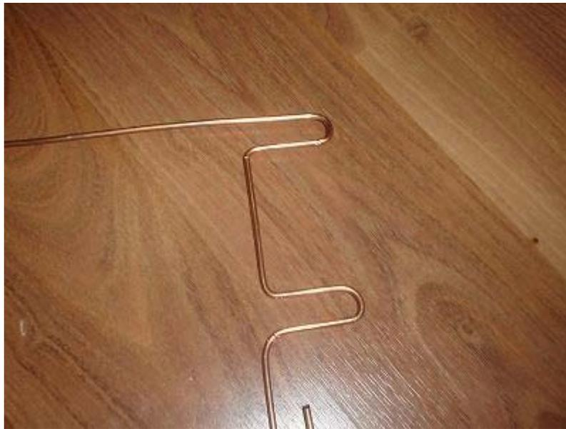
Luego medimos 30mm desde el final de la curva y doblamos hacia arriba y listo tenemos el segundo elemento de la antena.
