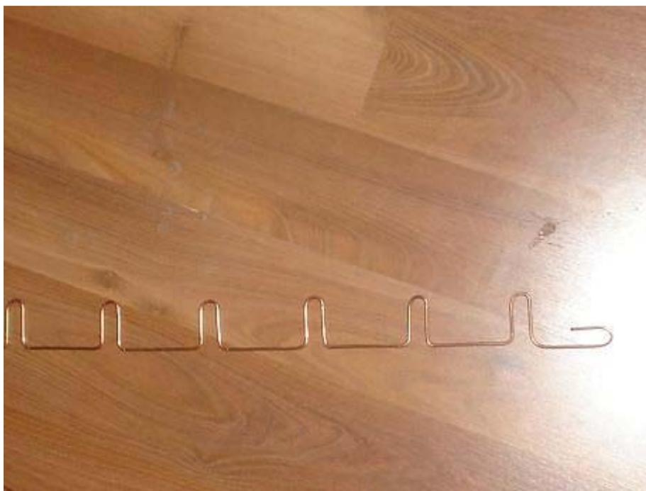
Ahora debemos preparala para la soldadura, tomamos una lima o dremel y raspamos un poco el cobre con la finalidad de facilitar la soldadura, luego medimos 10mm desde la curva hacia arriba y hacemos dos marcas en cada lado de la J. En esas marcas es que soldaremos el coaxial vean las imagenes.
