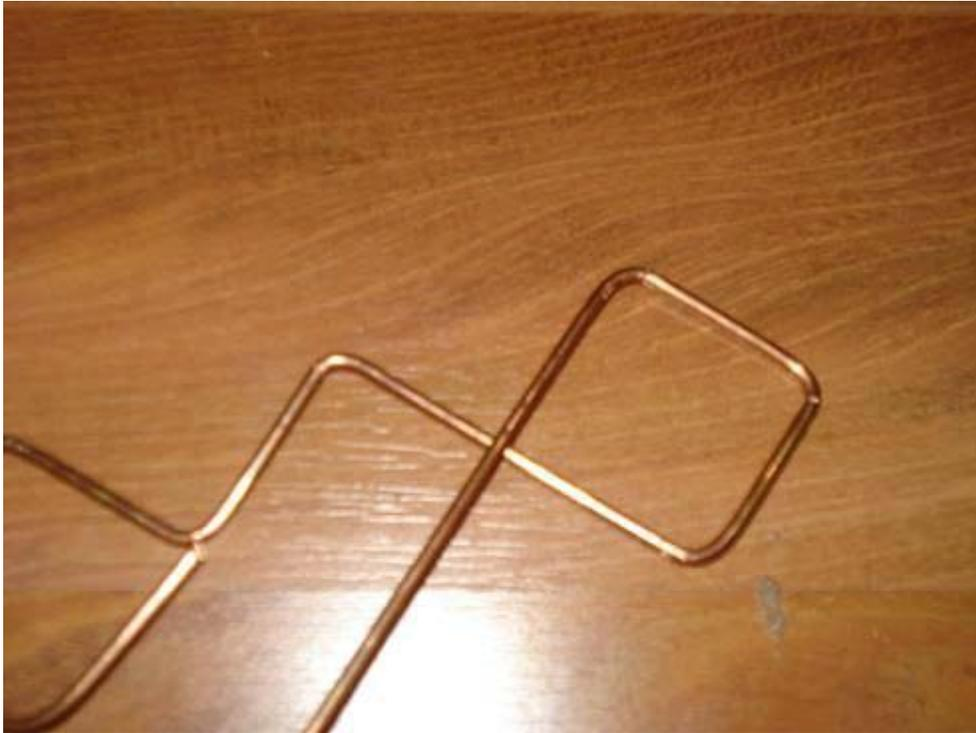
En el doble medimos 6.2 y en ese punto doblamos hacia la izquierda de la foto (centro) y listo ya tenemos nuestro alimentador biquad, seguramente les sobrara un poco de cobre en las puntas deben cortar estos excedentes hasta lograr los 3.1 cm y les quedara finalmente algo como esto.
