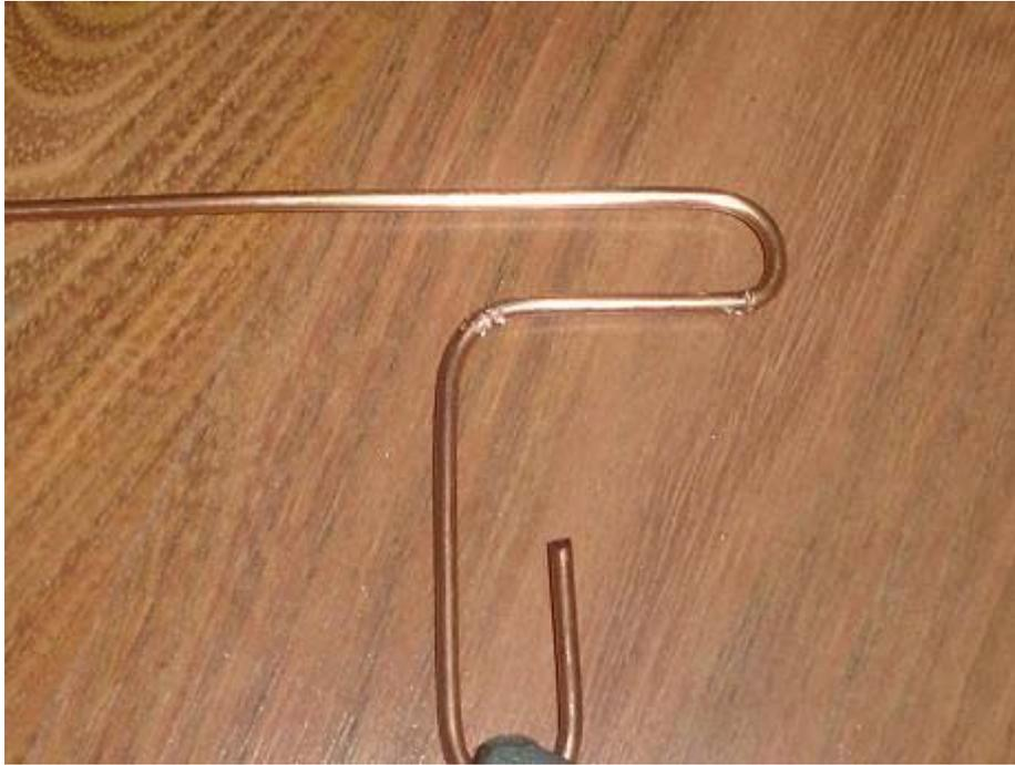
Ya tenemos listo el primer elemento, para hacer el proximo elemento medimos 60mm desde el final de la curva y alli marcamos y doblamos hacia la derecha de la J, luego medimos 30mm y hacia arriba. Finalmente colocamos la broca en el dobles y doblamos a la izquierda.
