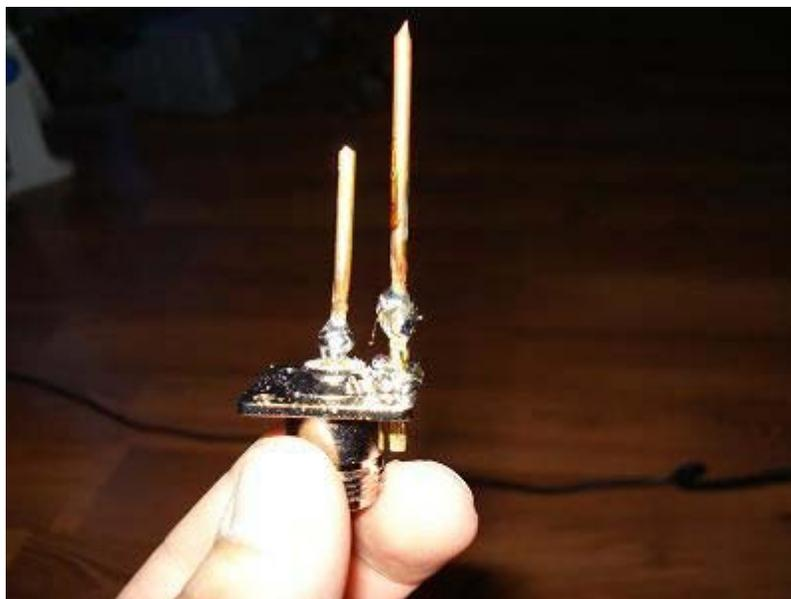
Ahora ya con el conector listo para soldarle el alimentador d-biquad lo introducimos al reflector asegurandolo bien con sus tornillos.
