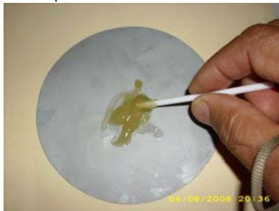
3.4.- Coloque el pegamento alrededor de la unión entre el tubo y la chapa en un diámetro de más o menos 1 a 1.5cm. Deje fraguar completamente por 1 hora.
