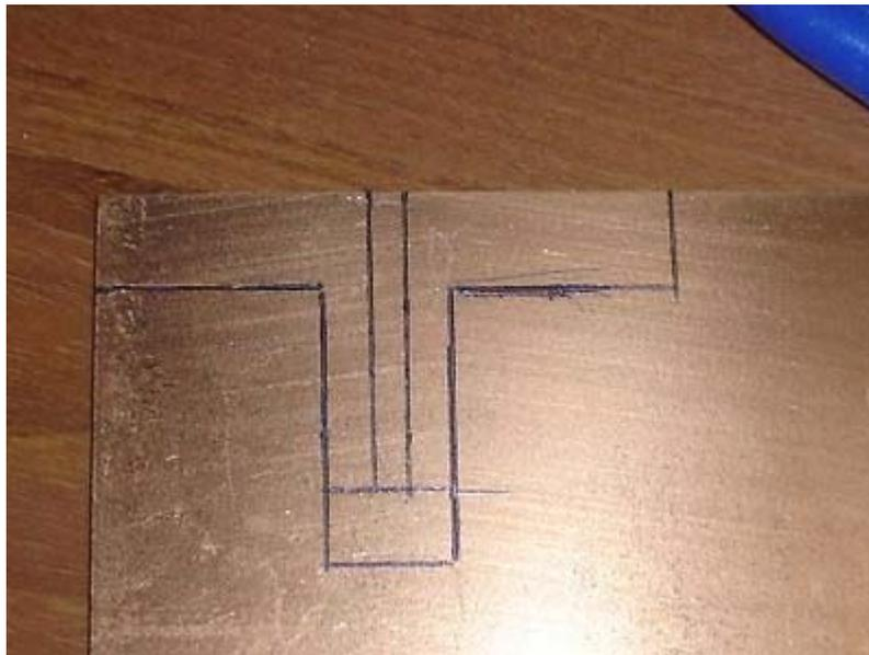
Una vez que tengamos dibujado el dipolo en la placa solo nos queda cortarlo, para ello recomiendo que usen un dremel o fresadora si no pues una cegeta, deben hacer los cortes al ras del dibujo no mas no menos que quede lo mas preciso posible. Si les queda un poco mas
