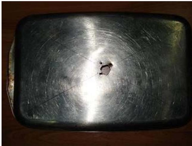
No me ha quedado muy bien que digamos, tuve algunos problemas el envase se puso algo rebelde. Alli se puede observar el orificio para el conector y los orificios para los tornillos.
