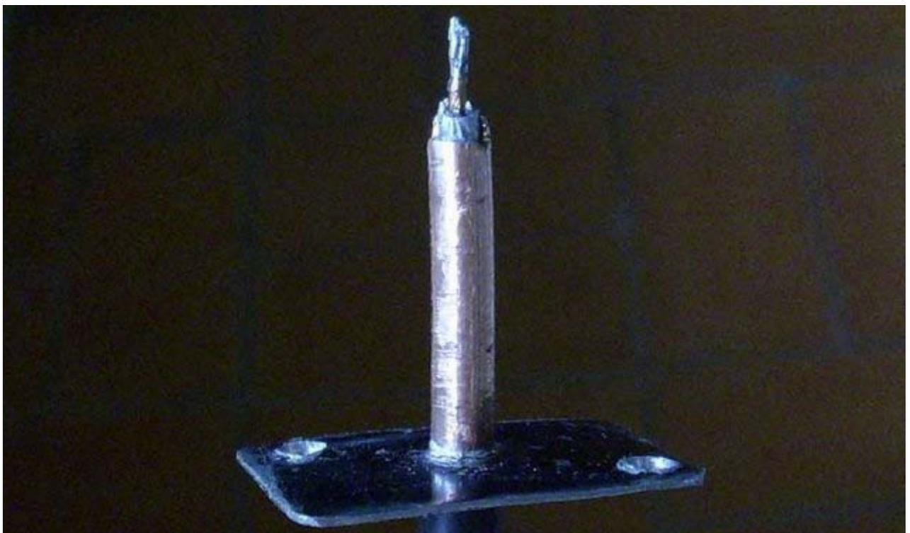
Tome las precauciones necesarias para evitar que luego el coaxial se mueva o deslice hacia afuera usando por ejemplo una abrazadera alrededor de la funda en la parte inferior.
