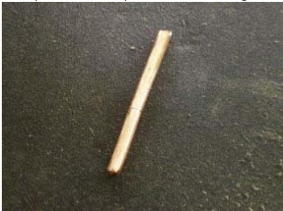
3.2.- Tome la chapa metálica, líjela bien y haga perforaciones para los tornillos y otra para que el tubo de cobre entre muy ajustadamente vale decir, que necesite forzar un poco para meterlo y llevarlo al sitio en donde se fijará (La muesca). Limpie con bencina o gasolina. Esto es para garantizar que habrá un buen contacto entre ellos y para la adherencia del pegamento.
