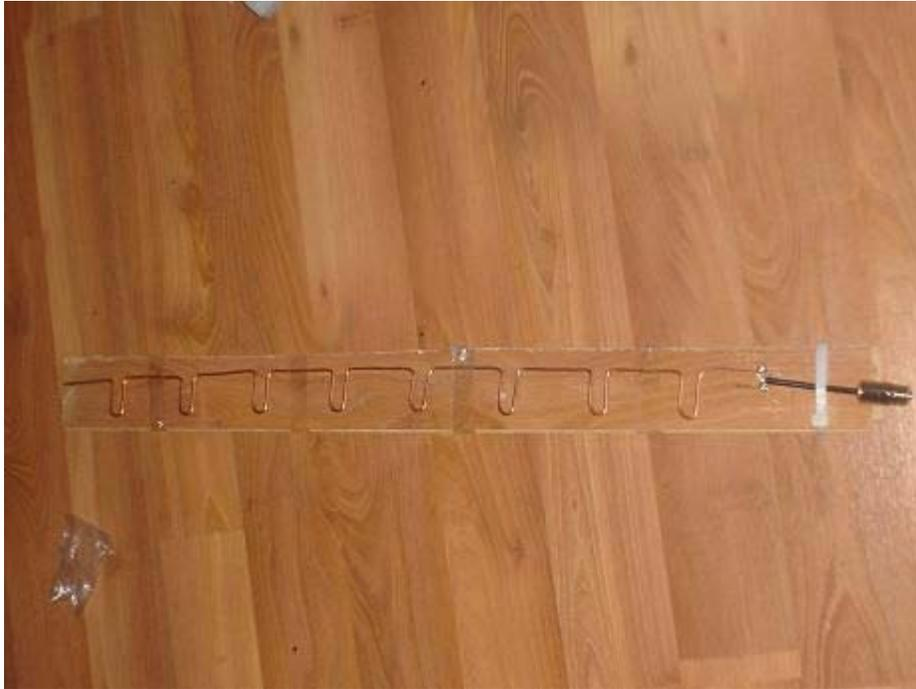
En esas ultimas imagenes pueden ver la soldadura entre el coaxial y la "J" y luego ya la antena terminada con su conector N-hembra ya lista para ser probada.
