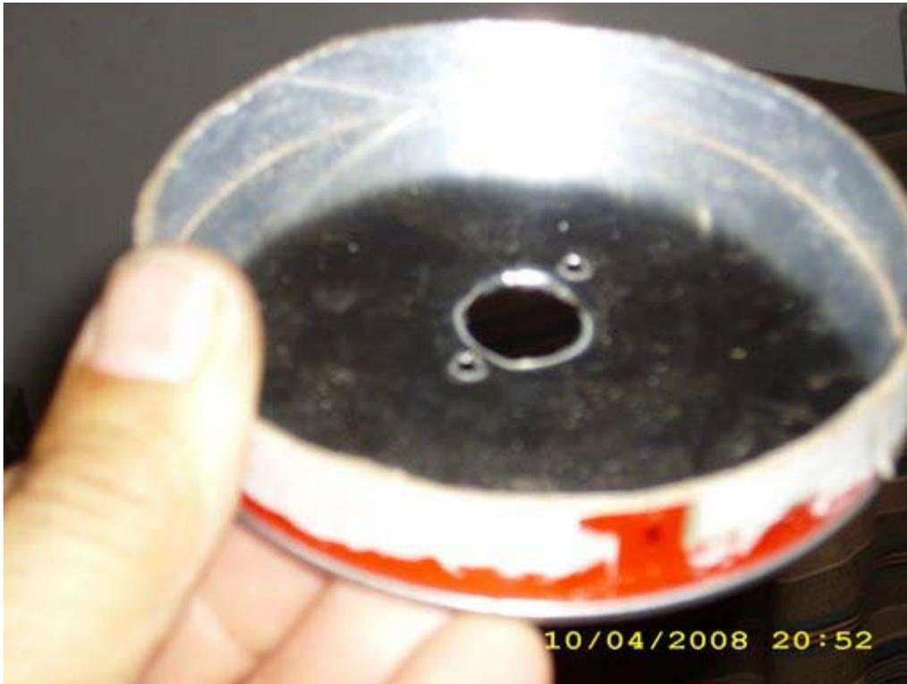
5.- Forrar la pestaña con adhesivo de papel de aluminio dejando unos 5mm. sobre el borde, doblar el adhesivo y forrar por el interior de la pestaña. Ver detalle de este adhesivo en link: [http://tache.unplug.org.ve/?page\\_id=20](http://tache.unplug.org.ve/?page_id=20)
