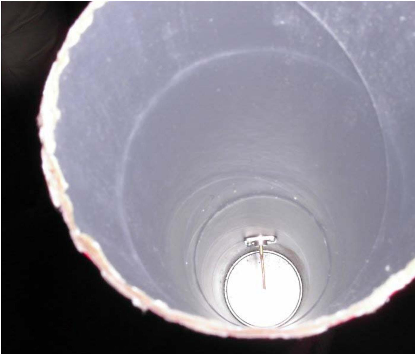
Ya que la colocamos bien, y la aseguramos, unimos la otra lata de pringles cortamos de la parte que tiene el fondo con mucho cuidado que quede recta, para que puedas poner la tapa de plástico y de allí lo unes con cinta de aislar..
