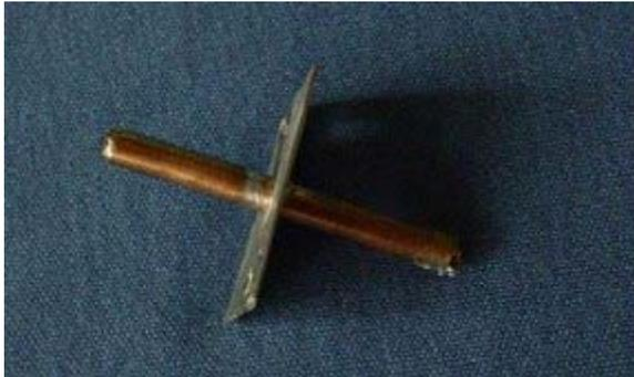
El tubo de cobre está soldado a una pequeña lámina que después se fijará con tornillos al reflector.
