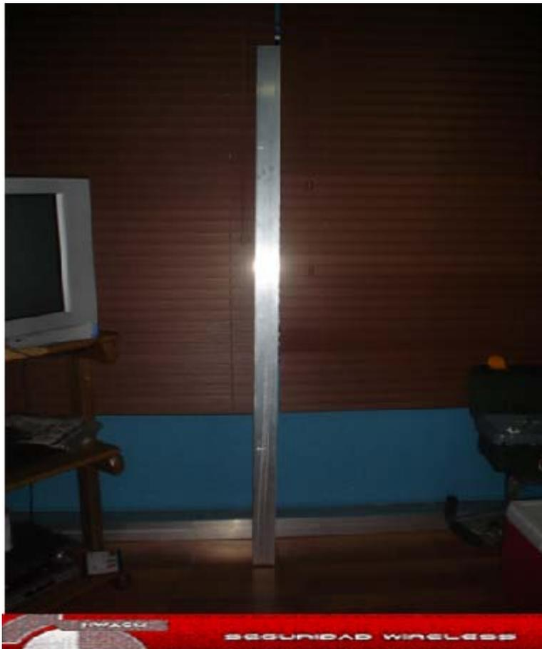
Antes de realizar el diseño ó de utilizar las calculadoras que les mostrare deben medir las dimensiones internas del tubo que han comprado y anotarlas para su posterior uso. Para ello les recomiendo que usen un vernier.
