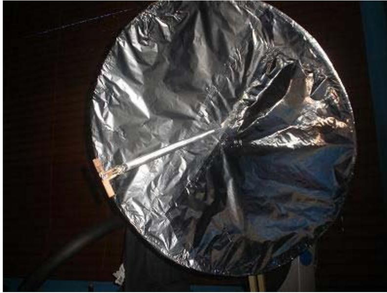
Con todo esto ya tenemos la antena lista para probar solo resta crimpar el extremo del cable con el conector de su agrado yo utilice un conector N-hembra.
