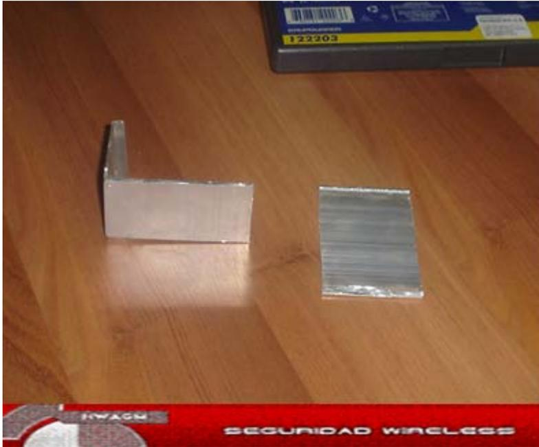
Recuerden que la pieza en forma de **L** va dentro de la guía donde la parte superior debe estar alineada con la línea que dibujaron y que representa el punto de partida de la antena, es decir la ubicación exacta de la tapa reflectora inferior. Mientras que la otra parte de la **L** debe estar sujeta al tubo.
