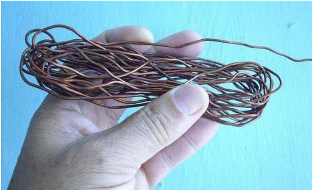
4ta. Vaya a la ferretería o venta de materiales eléctricos y compre un metro de cable No. 10 multifilar y quítele el forro protector. Tendrá material para unas 20 antenas BiQuad.
