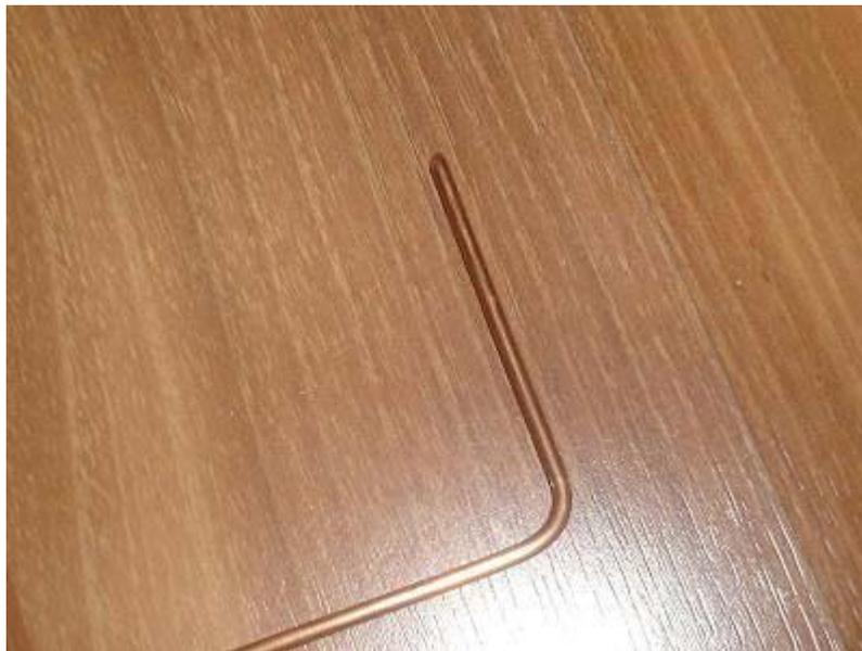
Tomamos la broca de 10mm y la colocamos en el dobles que hicimos, doblamos hacia arriba en paralelo con el alambre.
