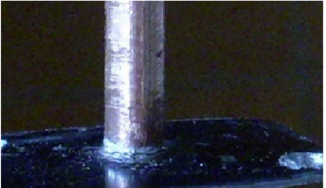
Después de soldar la pieza, haga un corte de 2mm de alto según se muestra en la imagen.
