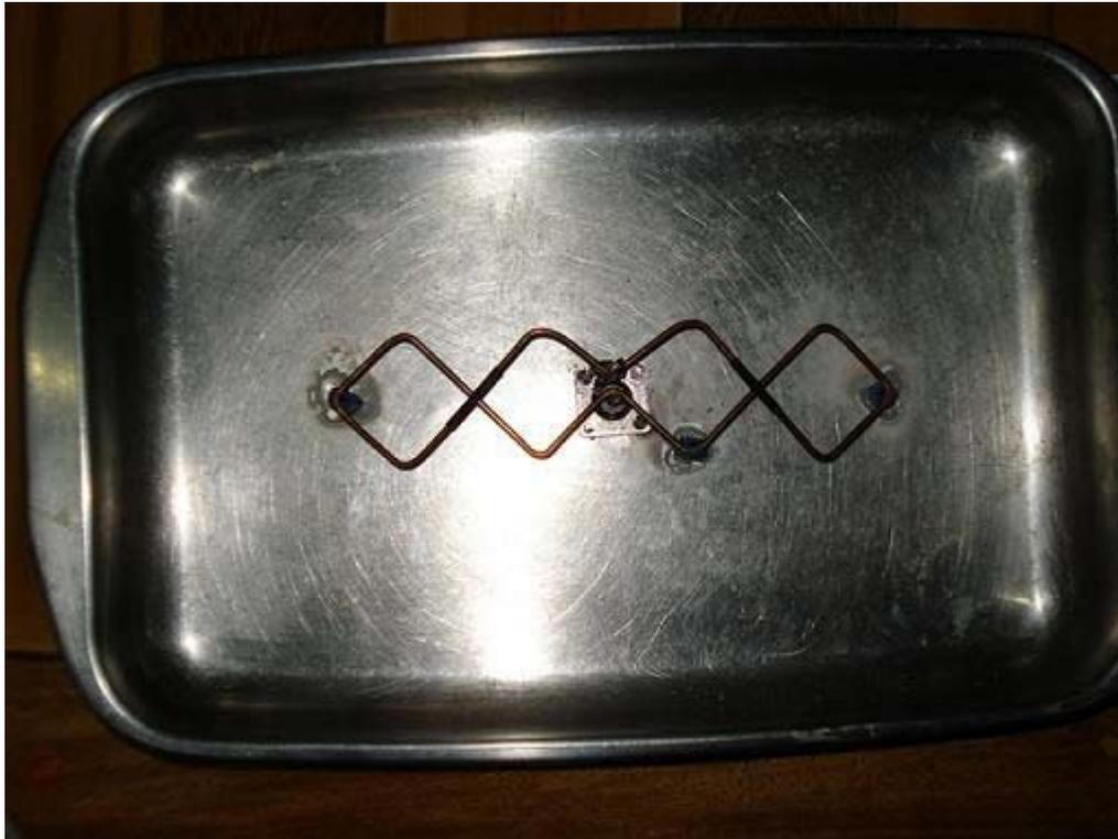
Bueno aqui pueden ver el alimentador ya montado solo falta cortar los excedentes de cobre y soldarla.
