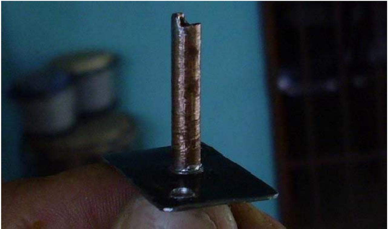
Corte la funda y la malla del coaxial hasta descubrir el vivo unos unos 2mm más largo que la separación entre la antena y el reflector y haciendo presión y girando la pieza encaje la parte inferior del tubo dentro del coaxial hasta que la funda haga tope con la chapa.
