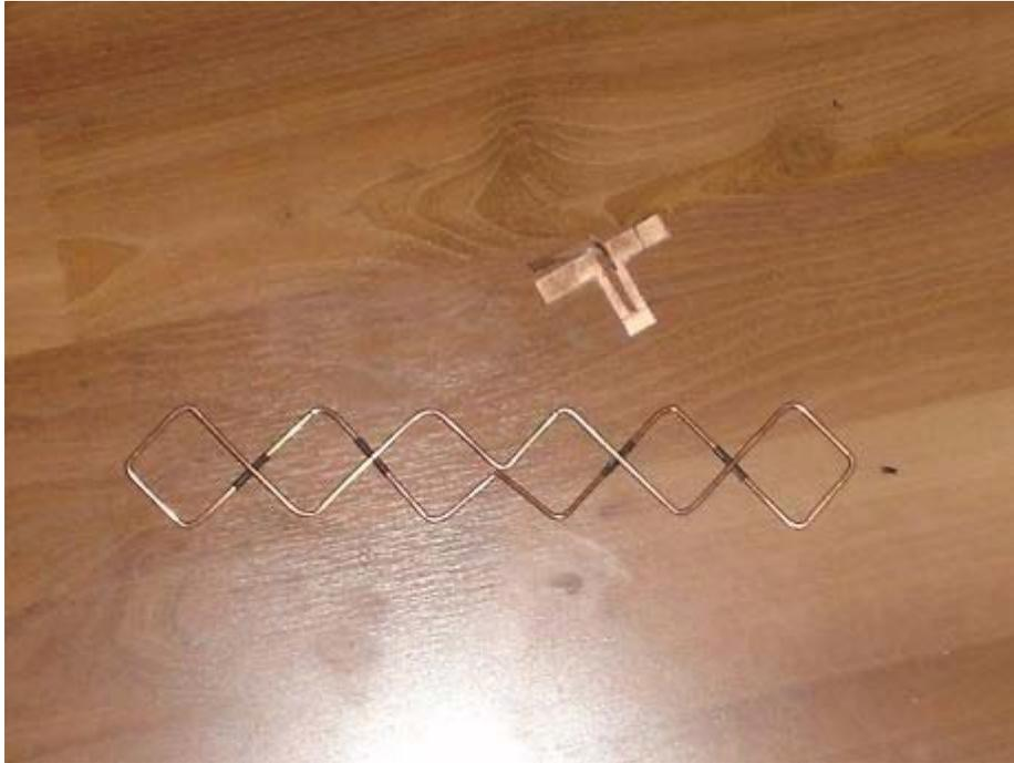
Como ven el alimentador triple-quad ya esta armado y listo para ser soldado y colocado en un buen reflector, tengo pensado buscar uno de esos envases de aluminio que utilizan en las tiendas de repostería si mismo Pueden ver como he puesto termocontraible en los lados que se cruzan para evitar que se toquen.
