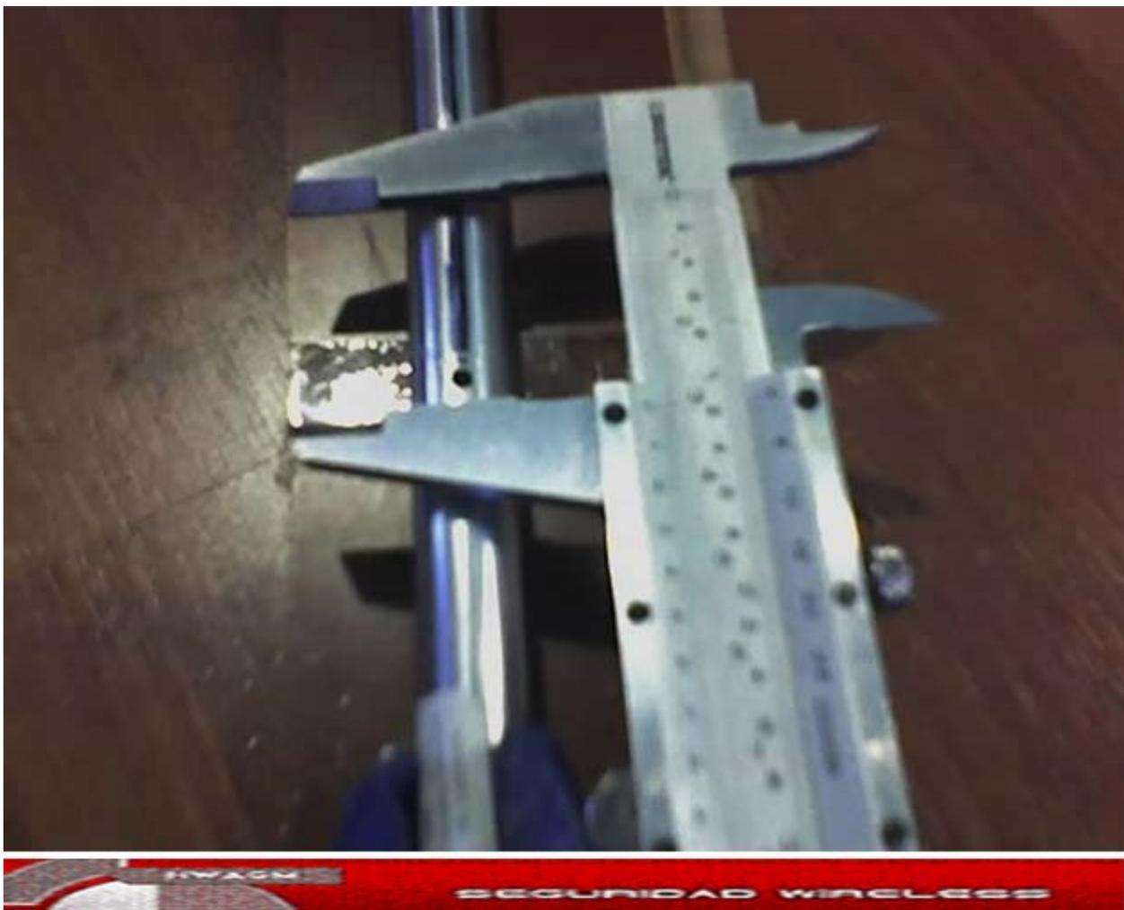
En ese punto hacemos el orificio para el iluminador, luego de igual forma miden y perforan el orificio para el primer director. El procedimiento a partir de aqui es el mismo deben repertirlo seguna las medidas indicadas por la hoja xls y segun el numero de elementos que desen agrgarle a la antena en mi caso con el Boon de 1 metro me alcanzo para 20 elementos.
