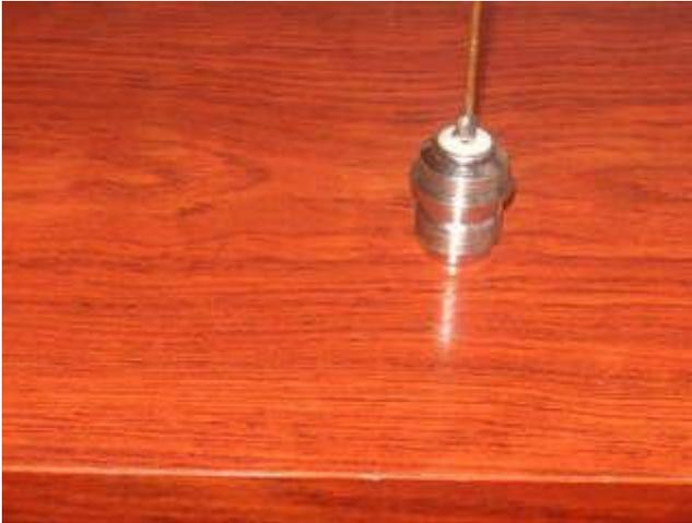
Y ahora solo queda cortar el alambre de cobre que hemos soldado al conector N-hembra.....Lo cortaremos a la mitad del diametro del tubo.....
