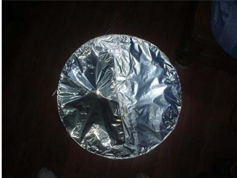
Ya tenemos el dipolo soldado al cable y el reflector listo, para acoplar el dipolo al relfector he introducido el cable en un tubo de aluminio de 1/2", posteriormente fije el cable al tubo con un poco de pegamento.
